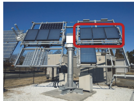
宮崎大学の CPV システム。赤枠の部分が水電解に用いられるモジュールである。 (写真提供：宮崎大学 西岡教授)
