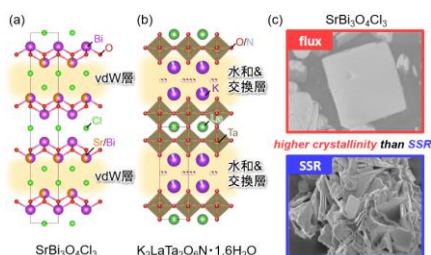
図 1. (a, b) 層状複合アニオン化合物、(c) \text{SrBi}_3\text{O}_4\text{Cl}_3 のフラックス合成
